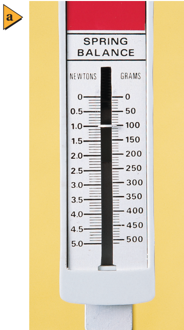
■ الشكل 1-12 عند النظر إلى التدريج بشكل عمودي كما في (a) تكون قراءتك أضبط مما لو نظرت بشكل مائل كما في (b).
