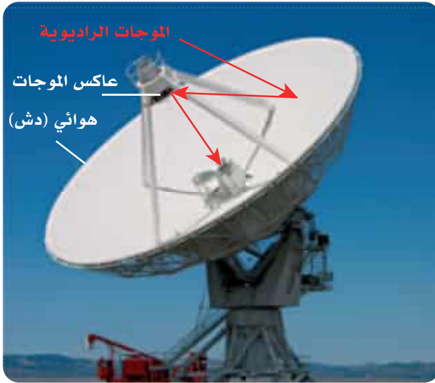
الشكل 14-3 تركيب المنظار الراديوي.
